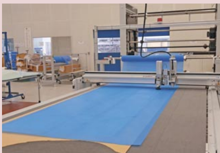
Bei Cotesa im Mochauer Gewerbegebiet „Am Fuchslotch“ werden aus Gewebe aus Glasfasern Flugzeugteile gefertigt: Zunächst wird dafür das hauchdünne, mit Harz verstärkte Material an einem Cutter entsprechend zugeschnitten (v. l. o.), anschließend werden die einzelnen Bestandteile in Form gebracht. In den Autoklaven (oben rechts) wird das Gewebe unter Druck verpresst und ausgehärtet. Bis zu 400 Grad Celsius können in diesen Druckkesseln erzeugt werden. Fotos(6): Maria Fricke
